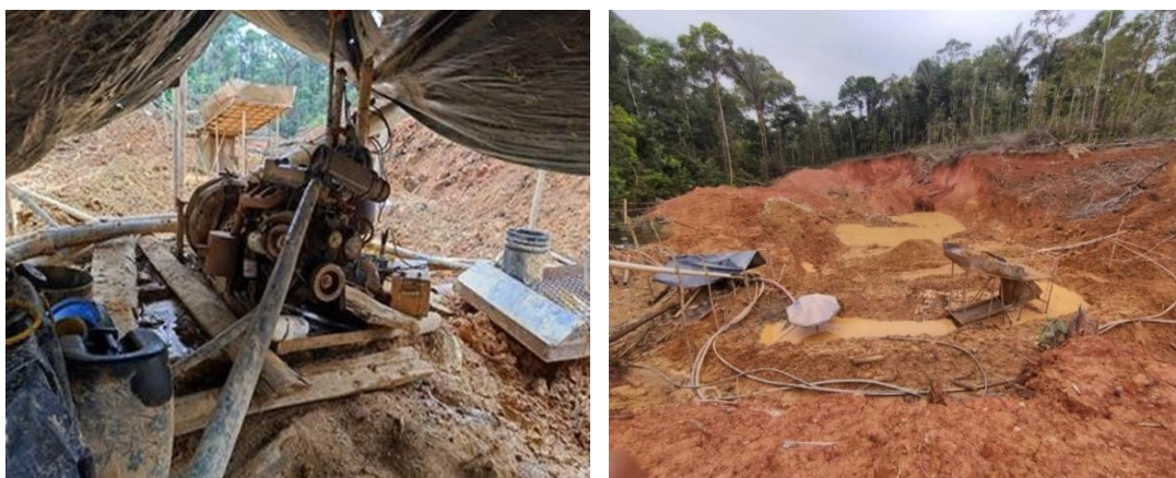
Fotografía 2.6 y 2.7 Lavado con uso de motobombas. Corpoamazonia 2022
